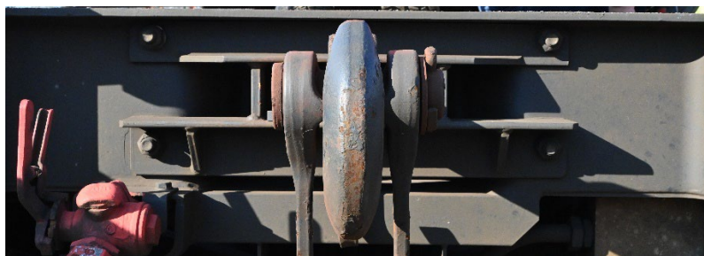
Figura 4: un esempio di sistema di sospensione del gancio
